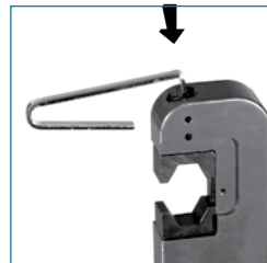
Upper die removal
